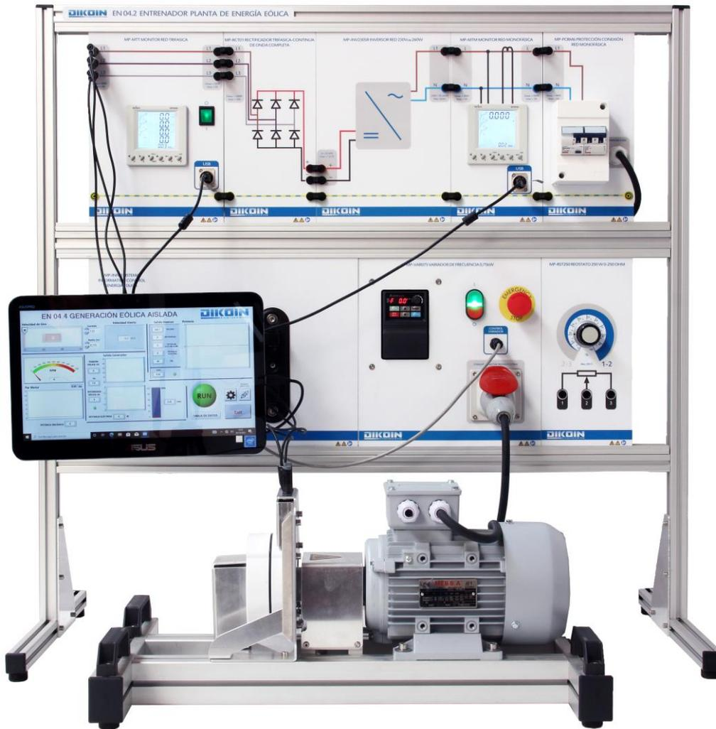
Con este equipo, emulamos el comportamiento de un aerogenerador de una manera práctica y didáctica. Un motor eléctrico hace las veces de las palas y el buje de un aerogenerador arrastrando a un generador síncrono trifásico de imanes permanentes, el cual transforma la energía mecánica transmitida al eje en energía eléctrica.
